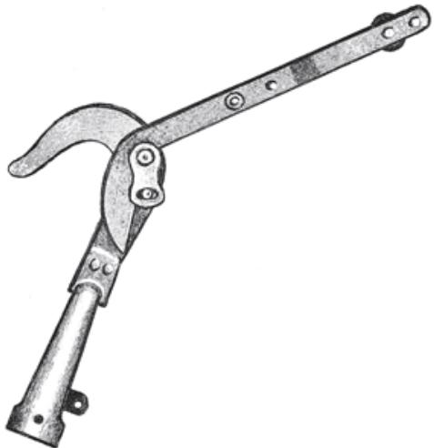
Рис. 48. Ручной сучкорез.
